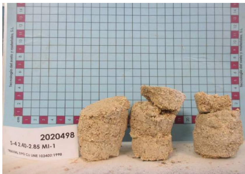
Detalle de las probetas después de ser sometidas al ensayo triaxial
