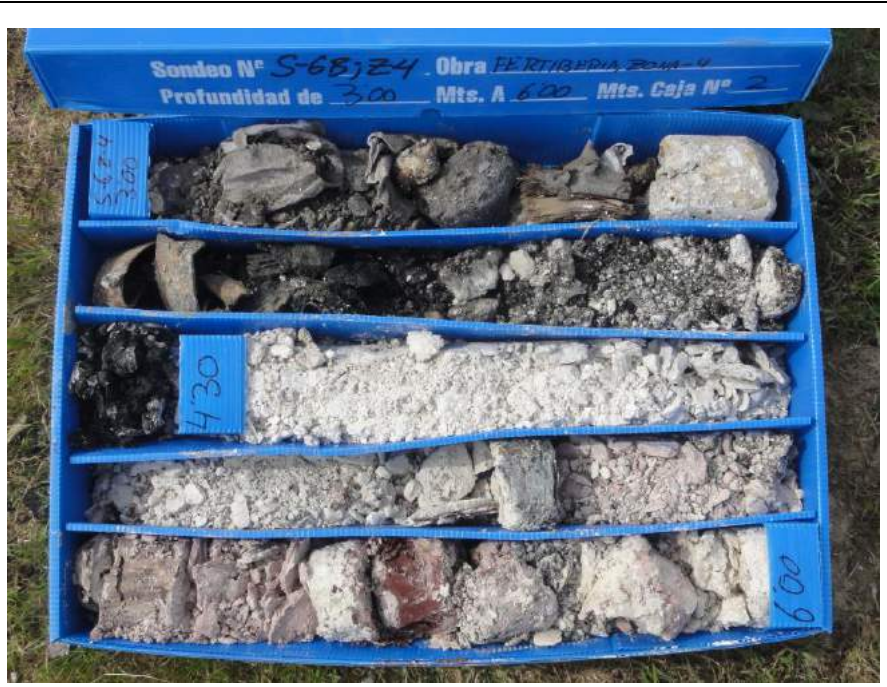
Sondeo S-6b, caja 2.- De 3.00 a 6.00 m
