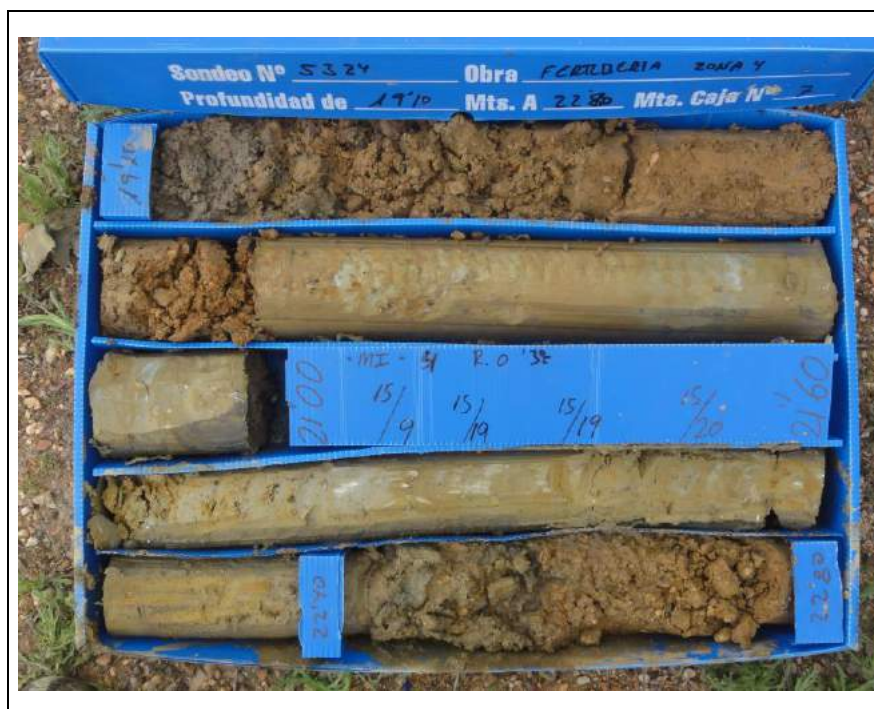
Sondeo S-3, caja 7.- De 19.10 a 22.8 m
