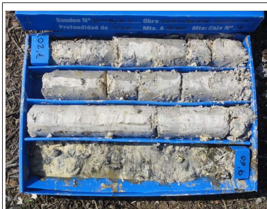
Sondeo S-4b, caja 3.- De 7.20 a 9.60 m
