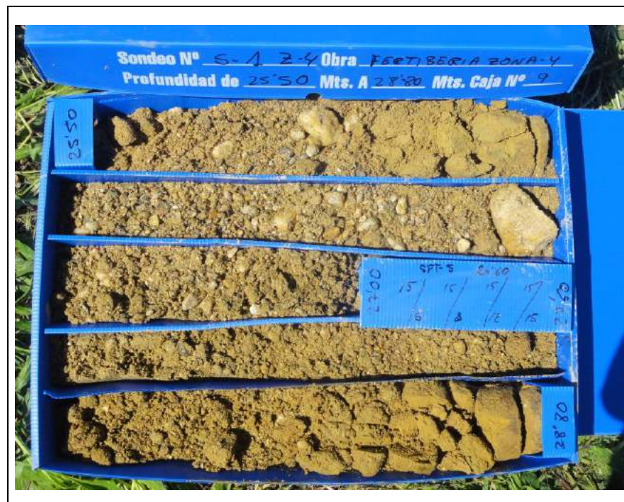
Sondeo S-1, caja 8.- De 25.50 a 28.80 m
