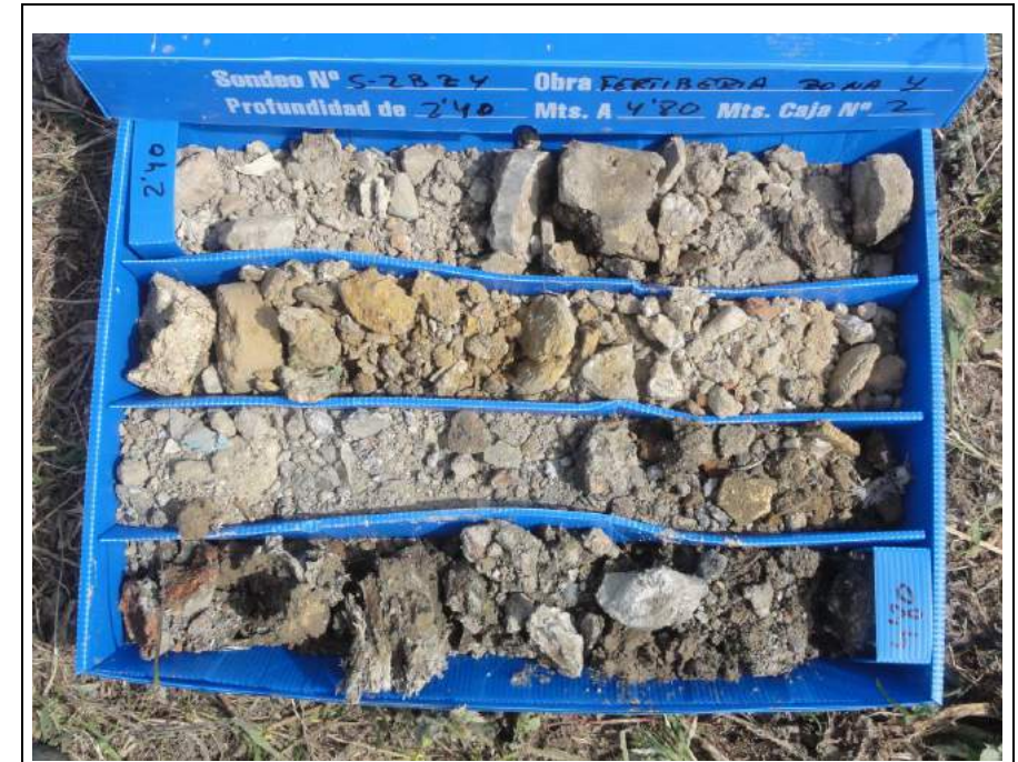
Sondeo S-2b, caja 2.- De 2.40 a 4.80 m
