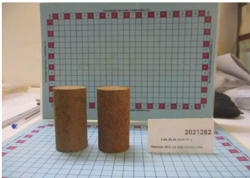
Detalle de las probetas antes de ser sometidas al ensayo triaxial
