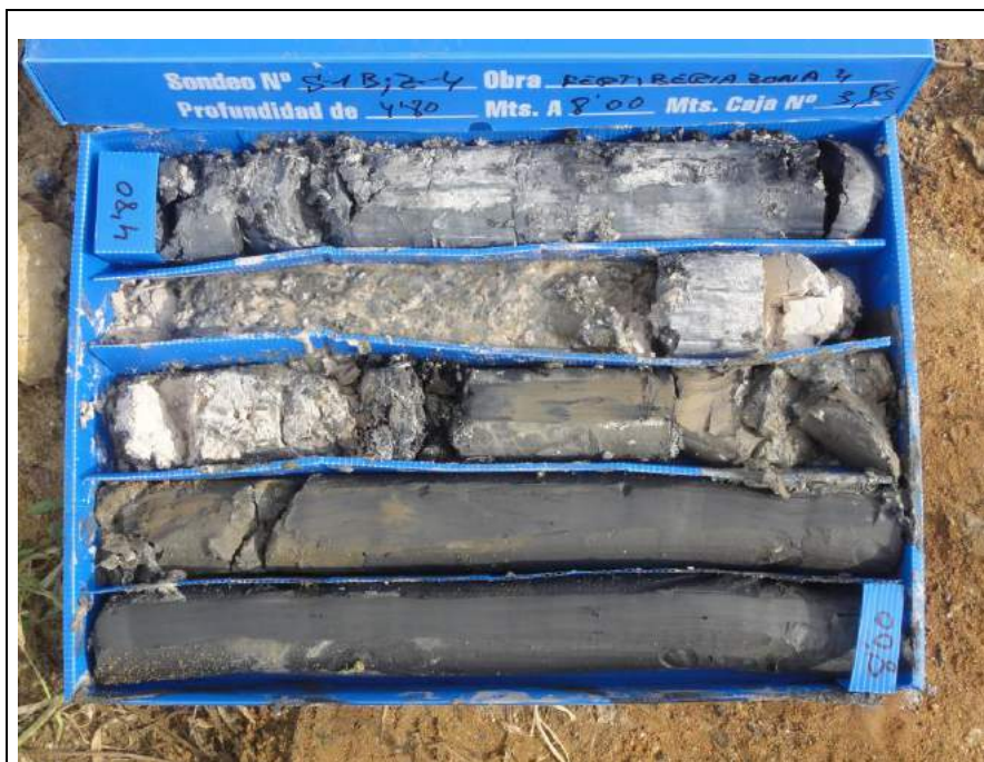
Sondeo S-1b, caja 3.- De 4.80 a 8.00 m
