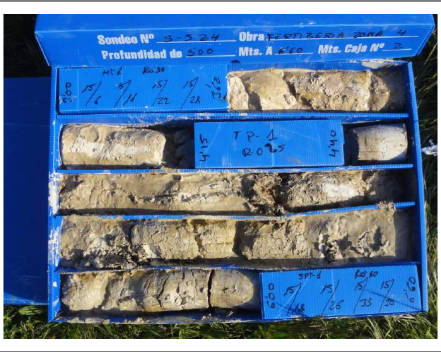
Sondeo S-5, caja 2.- De 3.00 a 6.60 m
