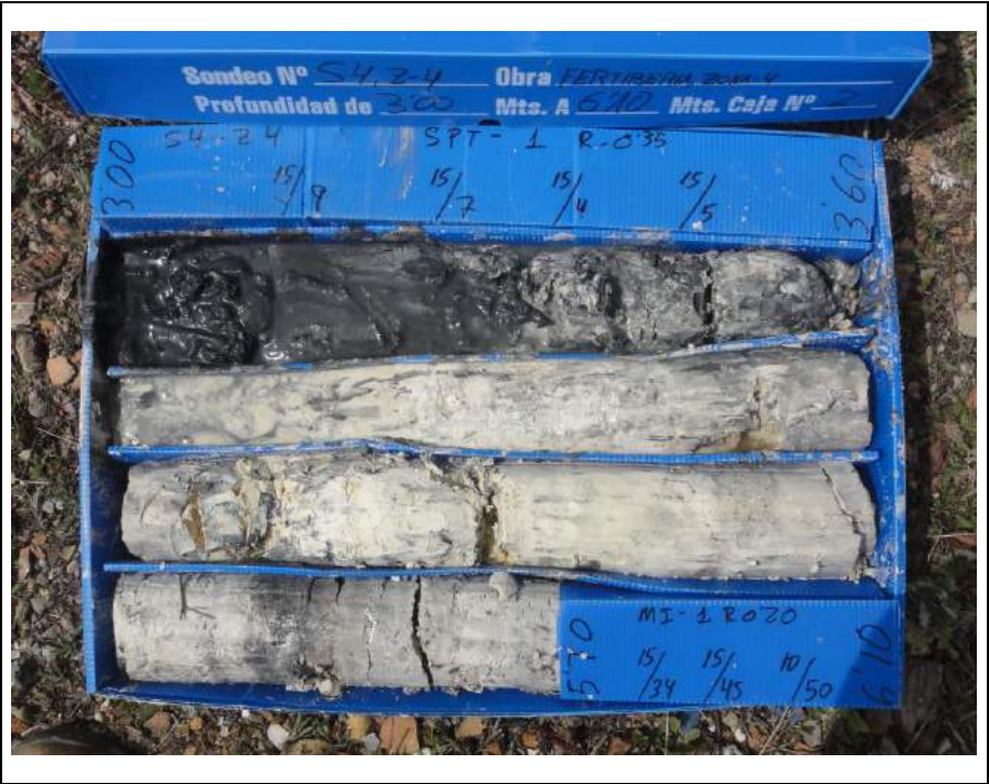
Sondeo S-4, caja 2.- De 3.00 a 6.10 m
