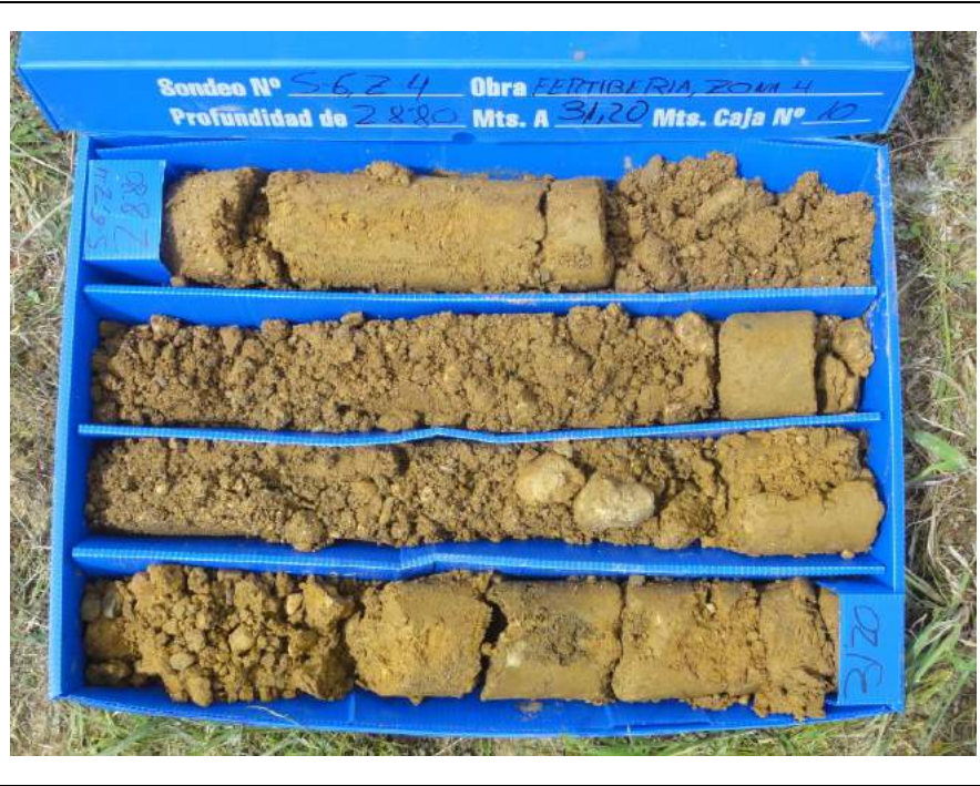
Sondeo S-6, caja 10.- De 28.80 a 31.20 m
